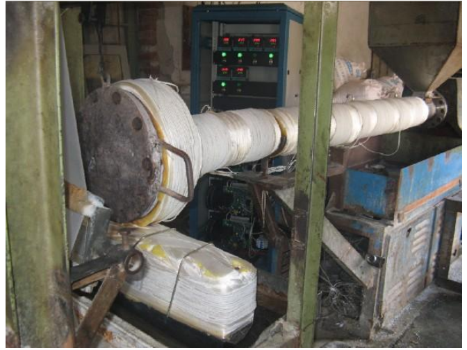
电磁加热在拉丝机中的应用实例
