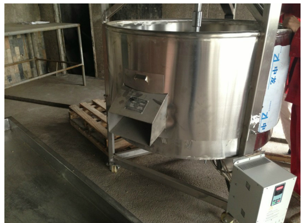
电磁加热器在各种食品机械（炒货机）的应用实例
