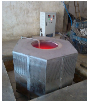
电磁加热在压铸机锌合金、铝合金熔炉加热中的应用实例
