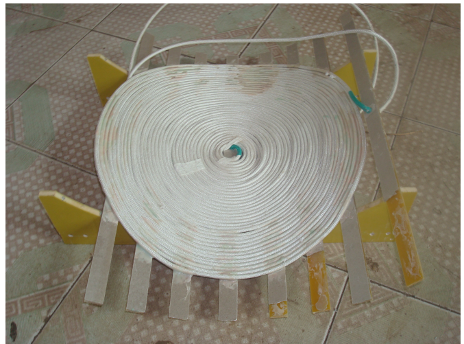
商用电磁炉线盘的制作案例
