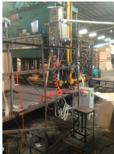
电磁加热在热压机多层压板机中的应用实例
