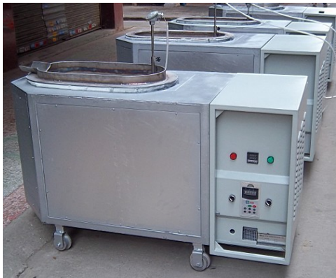
电磁加热在压铸机锌合金、铝合金熔炉加热中的应用实例
