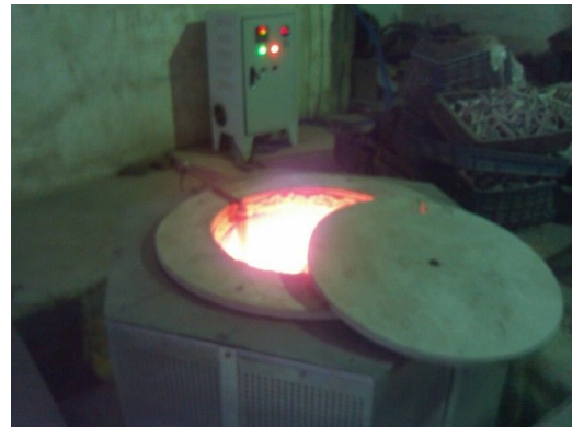
电磁加热在压铸机锌合金、铝合金熔炉加热中的应用实例
