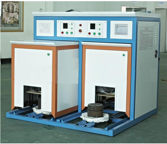
电磁加热在模具加热炉在的应用实例
