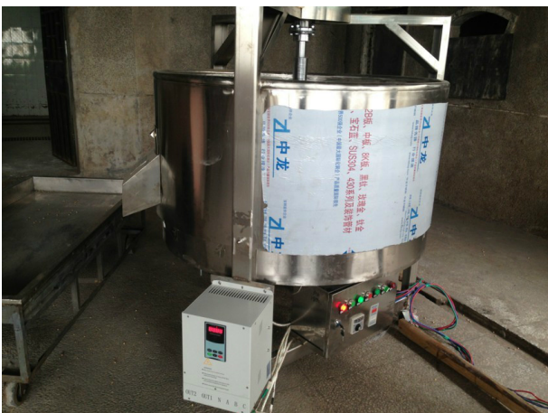
电磁加热器在各种食品机械（炒货机）的应用实例
