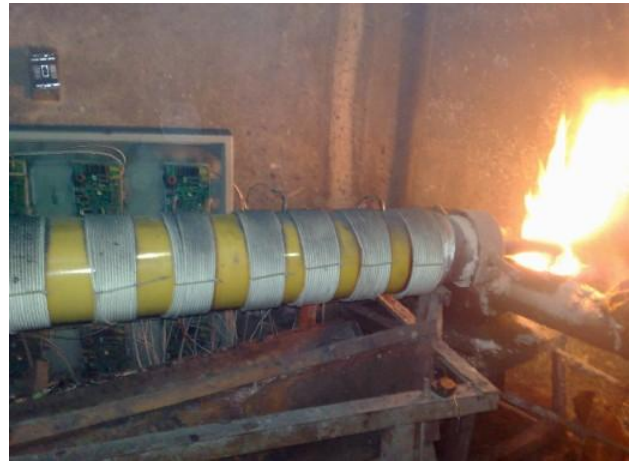
多台 5KW 组合在造粒机中的应用
