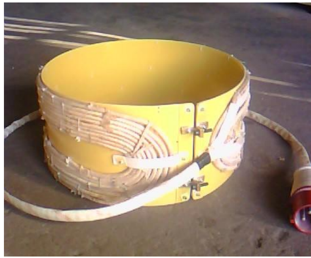
U形线圈（对扣式线圈）的制作案例
