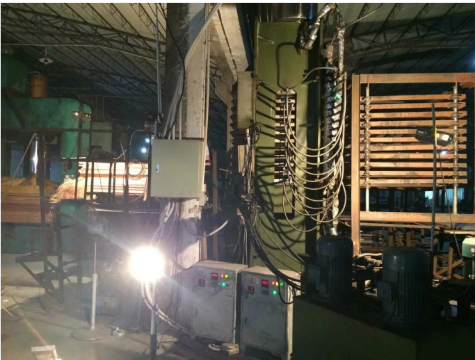
电磁加热在热压机多层压板机中的应用实例
