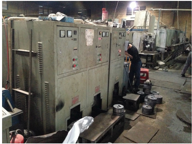
电磁加热在模具加热炉在的应用实例
