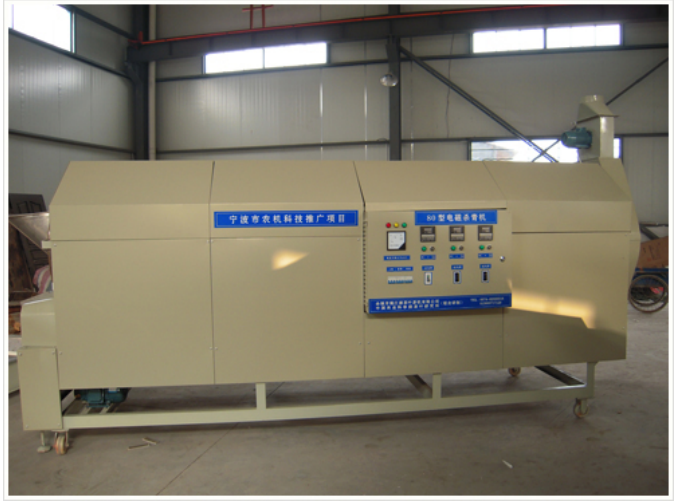
电磁加热器在各种茶叶机械（茶叶杀青机与滚烘机）中的应用实例
