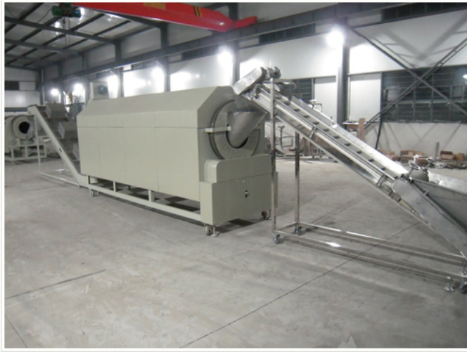
电磁加热器在各种茶叶机械（茶叶杀青机与滚烘机）中的应用实例
