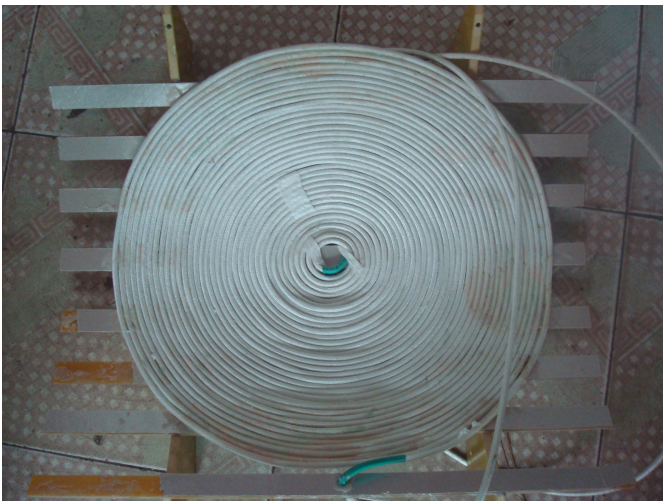
商用电磁炉线盘的制作案例
