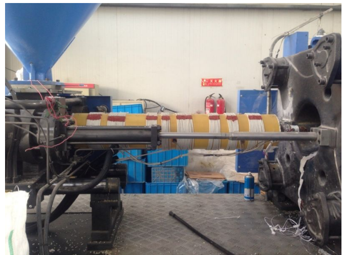
电磁加热在注塑机中的应用实例
