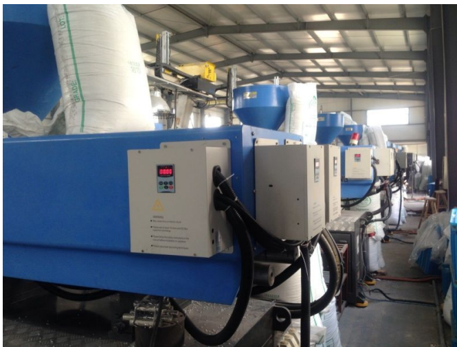
电磁加热在注塑机中的应用实例
